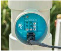
01 ゲート式の開水路の給水バルブにワタラスの子機を取り付けます。手動と遠隔操作の切り替えも可能。
