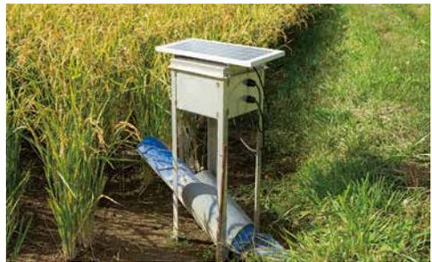
03 農匠自動水門はバッテリーが内蔵され、上部のソーラーパネルで充電。ボックスの下には水路とつながったホースがあり、ホースが上下して給水・止水します。遠隔操作はできませんが安価に導入できます。
