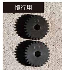
02 移植機のギヤ2個を交換するだけで、植え付けの株間を変更できます。右は株間14cmの慣行栽培、左は株間26cmの疎植栽培の組み合わせ。
