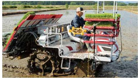
01 移植には植え付け部の掻き取りツメなどを変更した専用の田植機が必要。苗箱の数や苗の補給回数は大幅に削減できます。
