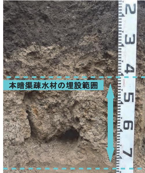
図5 無材補助暗渠（パンブレーカによる心土破碎）
