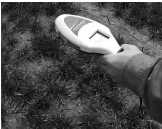
写真1 携帯型 NDVI センサ (GHCS) の測定の状況
