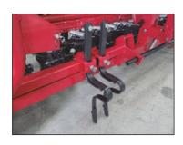
タイヤ跡消しの位置と深さをトラクターに合わせて調整します。
