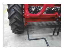
両端のコルターは個別で調整。 本機タイヤの真後ろにあるため、 他の箇所より強めに調整します。
