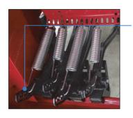
前方のスプリングで、それぞれのコルターの圧力を3段階で調整することができます。
