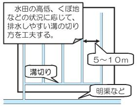
図3 溝切りの施工方法
