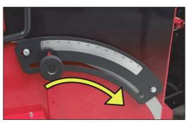
※ 調整する際には一気に目標 の数値に移動させるのではな く、左右に振りながらレバーを 移動させてください。
