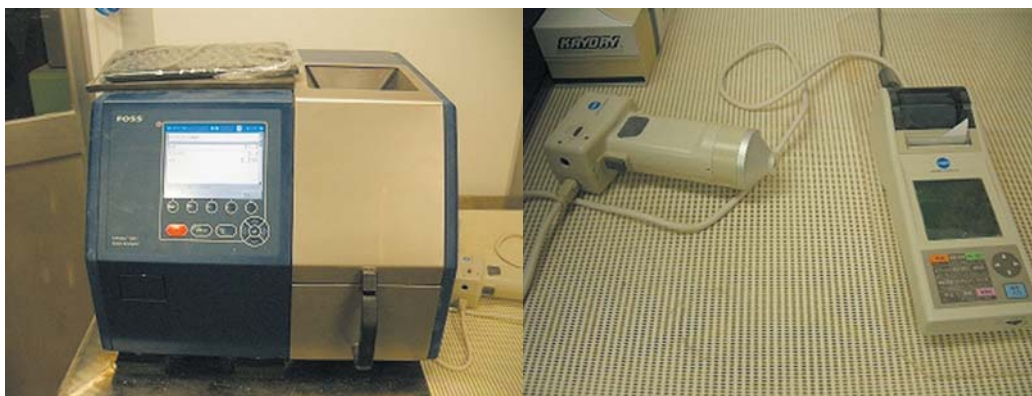
写真11 左：FOSS 水分・タンパク・灰分測定器、 右：MINOLTA 色彩色差計
