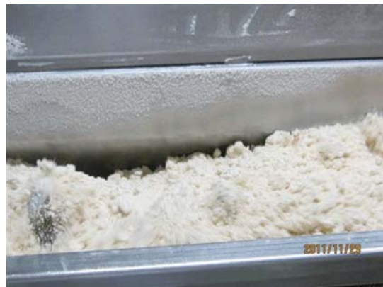
写真3 小麦粉と塩・水等を混ぜて生地を作る。
