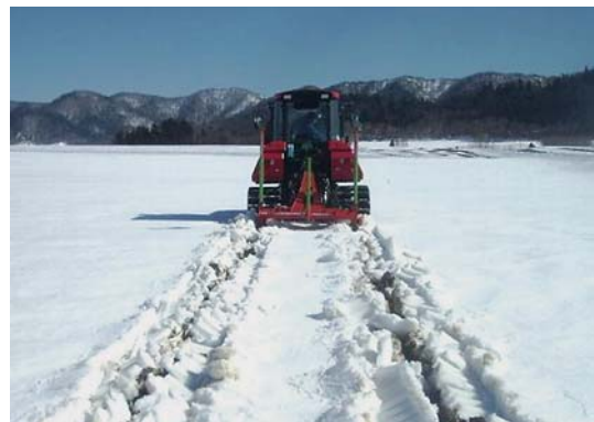
写真1 雪上心土破碎の作業風景
