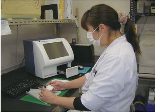
写真1 インフラライザーによるタンパク質含有率測定の様子
