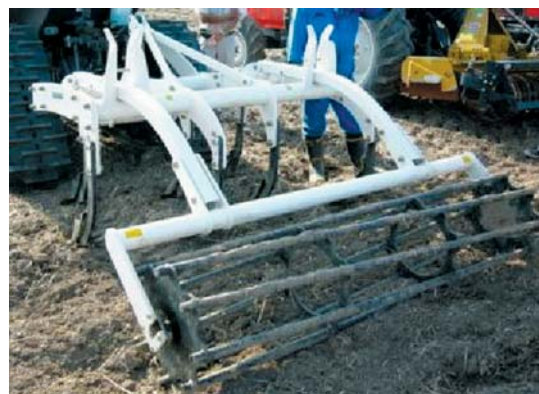
写真3 スタブルカルチ施工
