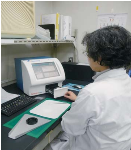
写真1 インフラライザーによるタンパク質含有率測定の様子
