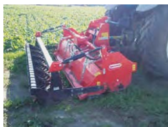
ロータリーハロー+鎮圧ローラー
