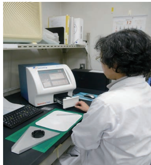
【写真2】 インフラライザーによる精米たんぱく質含有率測定の様子
