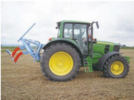
写真1. 無材暗きょ施工機「カットドレーン」の外観
