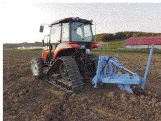
写真5 カットドレーン施工
