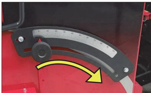
※ 調整する際には一気に目標の数値に移動させるのではなく、左右に振りながらレバーを移動させてください。
