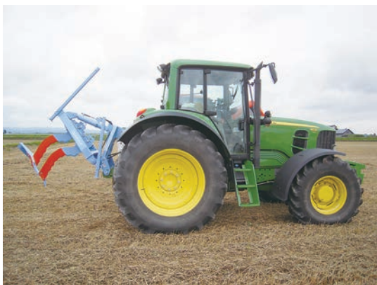
写真1. 無材暗きょ施工機「カットドレン」の外観
