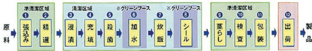
図 ウーケにおける無菌包装米飯の製造工程
