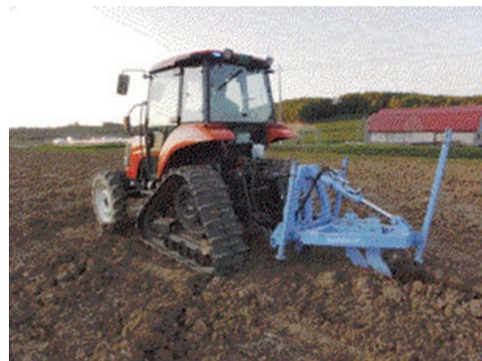
写真5 カットドレーン施工
