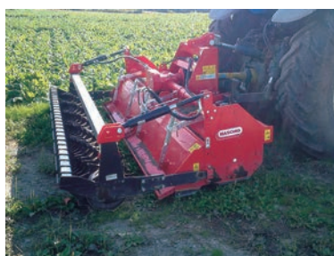
写真6 ロータリーハロー+镇压ローラ
