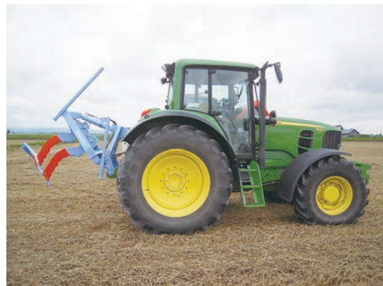
写真 3. 無材暗きょ施工機「カットドレーン」の外観
