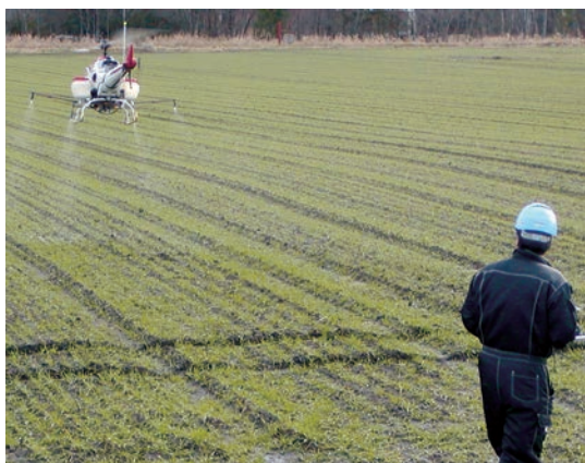
写真2 ラジコンヘリコプターを使用した雪腐病防除
