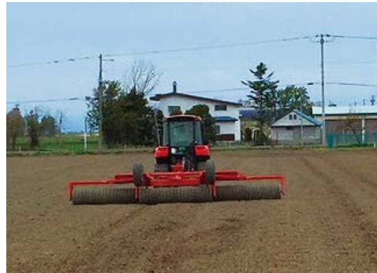
写真12 ケンブリッジローラーで鎮圧
