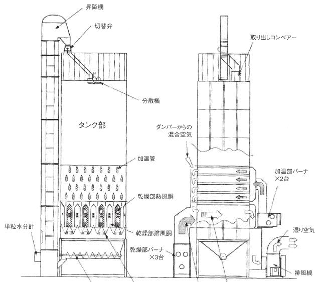
図2-13 加温管方式の乾燥機
