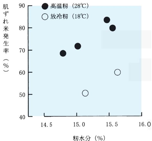
図3-2 粒温度と肌ずれ米発生率
