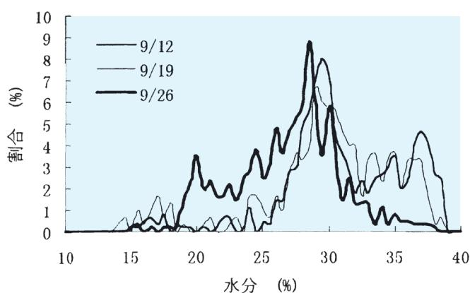
図2-1 コンバイン収穫穀の単粒水分分布
