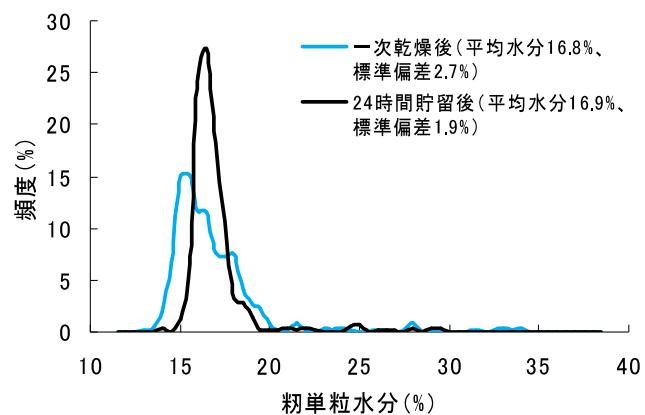
図2-4 貯留時の単粒水分分布の変化
