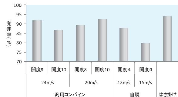
図1-6 機種別の脱穀条件と低温発芽率 (中央農試)
