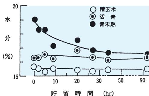
図2-6 二段乾燥後の水分変化（山形農試）
