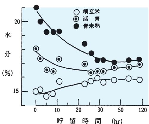
図2-5 一次乾燥後の水分変化（山形農試）
