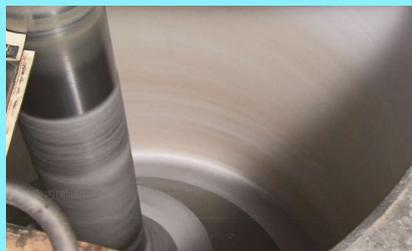
砂糖の結晶が大きくなったら遠心分離機に入れて、結晶と水分（糖蜜）に振り分け乾燥させます。
