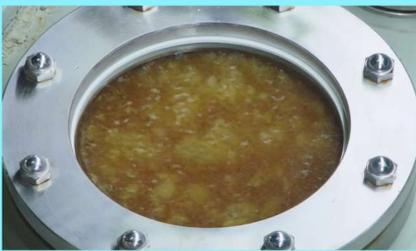
ろ過された糖液を煮つめて水分を飛ばし濃縮したあと、細かな砂糖を加え更に煮つめると、砂糖の結晶が成長します。
