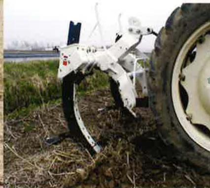
カッティングソイラ工法：心土に堆肥投入し排水性を改善する新しい心土改良耕です
