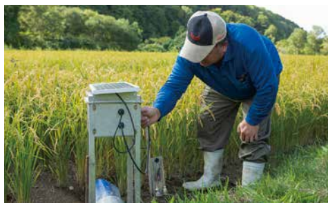
01 農匠自動水門は手軽に設置できます。取り付けや取り外しは横関さん自ら行えます。
