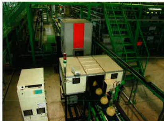
光センサーによる糖分測定と外観計測装置
