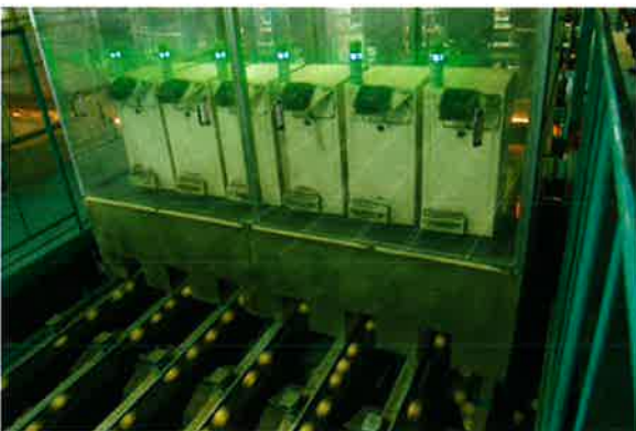
光センサーによる内部空洞個体のより分け
