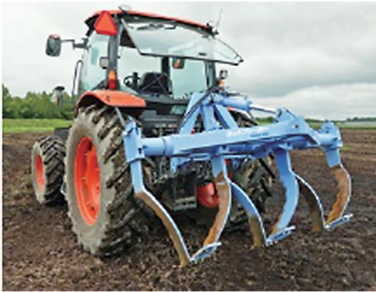
写真5 全層心土破碎機(カットブレーカー)
