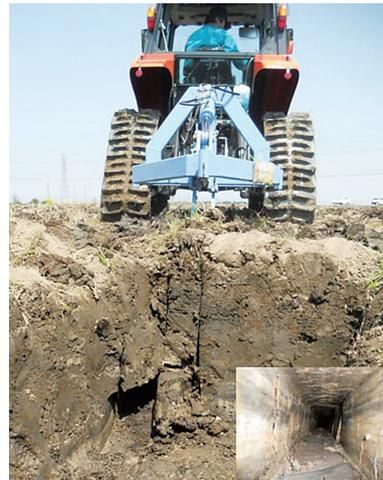
写真6 穿孔暗渠機(カットドレーン)
