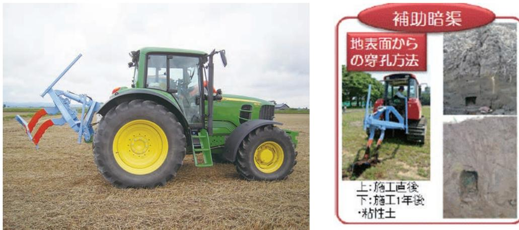
図7 カットドレーンの外観と施工の概要
