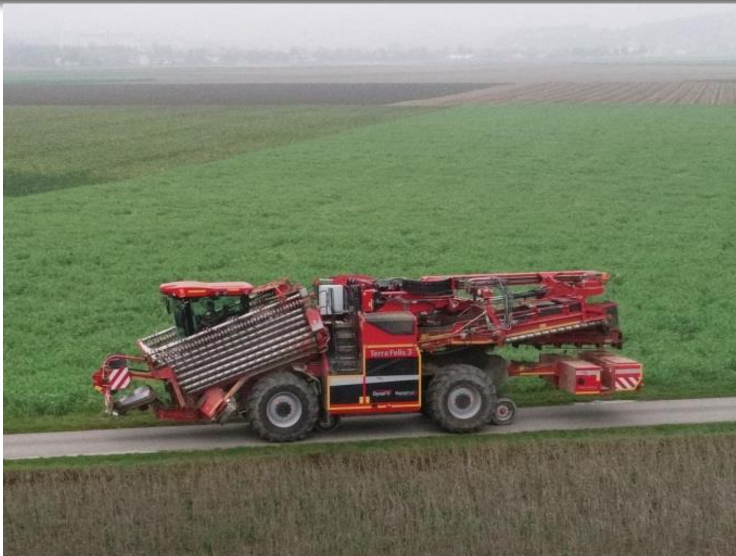
写真 2－11 自走式除土積込機の走行風景
