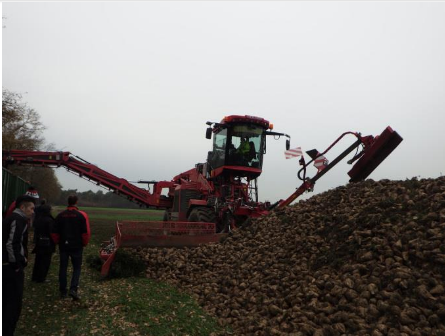
写真 2－10 自走式除土積込機の作業風景
