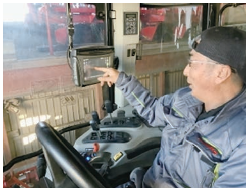
写真2 GNSS自動操舵装置を搭載
