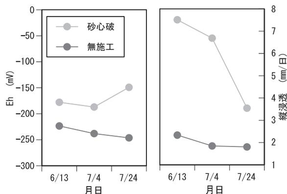
図7 砂心破が縦浸透と酸化還元電位に及ぼす影響
