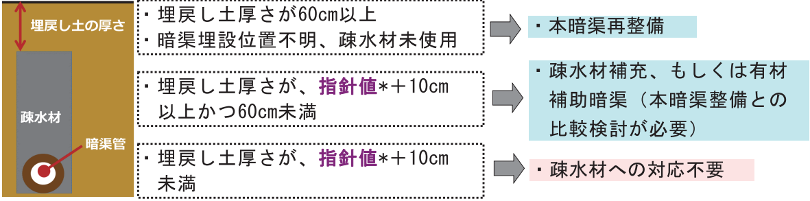
図3 疎水材暗渠の排水機能簡易診断と機能回復手法
