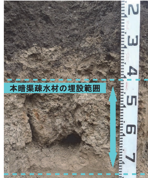
図6 無材補助暗渠（パンブレーカによる心土破碎）
