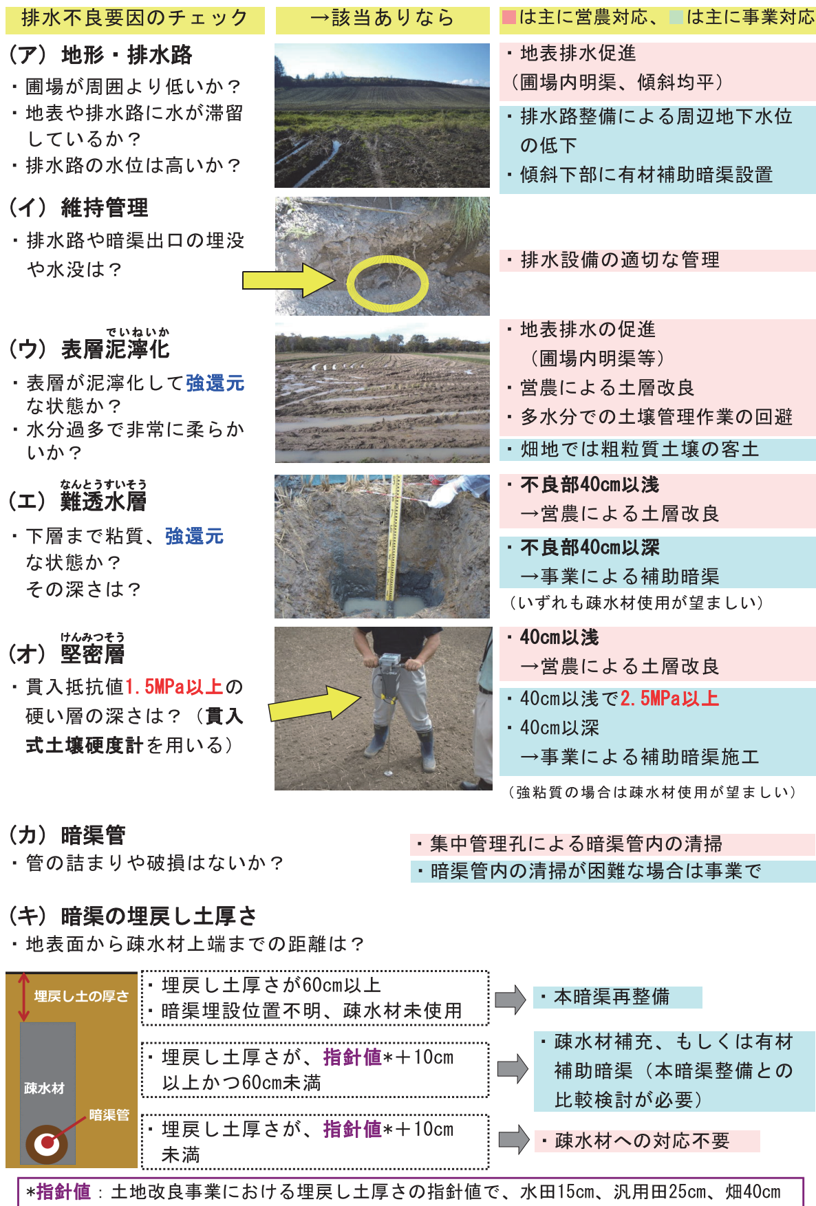
図3 疎水材暗渠の排水機能簡易診断と機能回復手法
