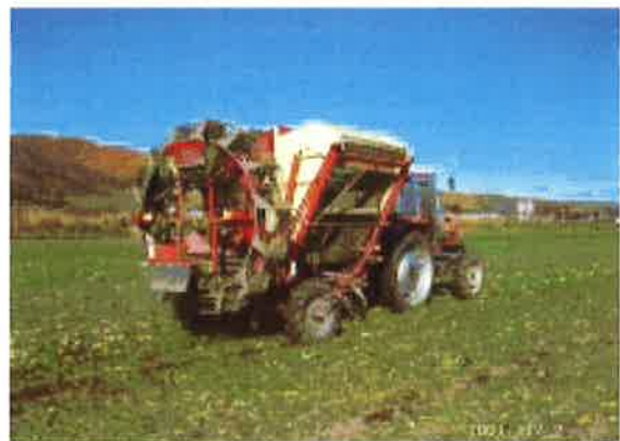
1 畦用収穫機による収穫作業
