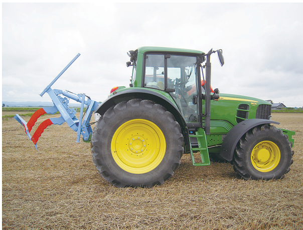
図7 カットドレーンの外観と施工の概要
